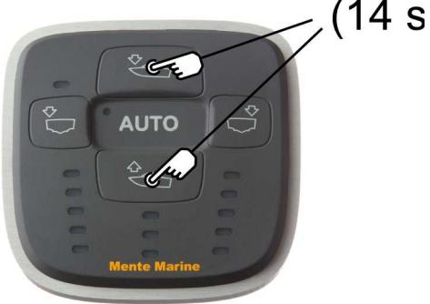
Die Anzeige AUTO blinkt und zeigt an, dass eine Kalibrierung notwendig ist. Drücken Sie die oberste und unterste Taste gleichzeitig für etwa 5 Sekunden, um eine Kalibrierung zu starten. Halten Sie die Tasten für noch 9 Sekunden gedrückt, während das ACS kalibriert wird.
