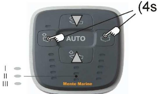
Drücken Sie die linke und rechte Taste gleichzeitig für 4 Sekunden, bis eine Anzeige in der Mitte anfängt zu blinken.
