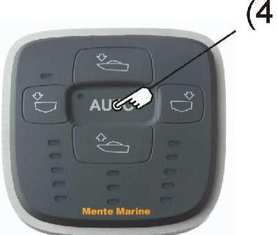
Fahren Sie das Boot mit normaler Gleitgeschwindigkeit. Trimmen Sie das Boot manuell bis Sie den optimalen Trimmzustand eingestellt haben. Danach drücken und halten Sie die Auto-Taste für 4 Sekunden unten, bis die AUTO-Anzeige aufleuchtet.
